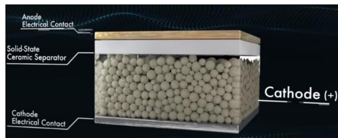
8. ábra: A szilárdtest Li-fém akkumulátor elvi rajza. [8]
