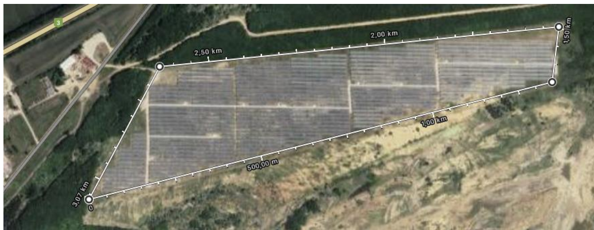
12. Ábra: Bükkábrányi naperőmű (32 hektár, 22,5 MW beépített kapacitás)
